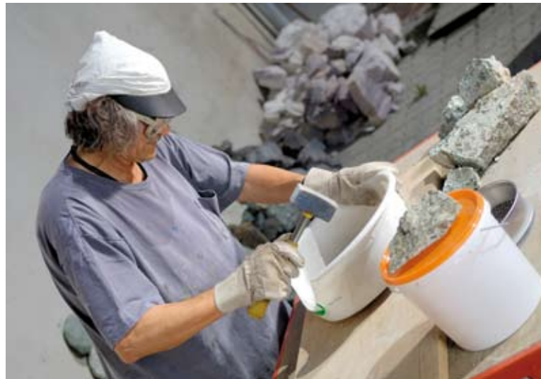
Die Brocken werden zerklopft, gesiebt und umgeschüttet.
